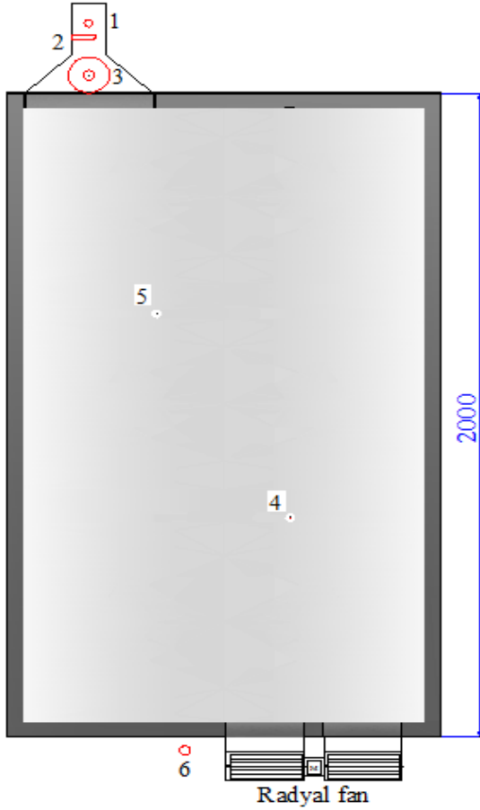
Şekil 3. Kollektör ölçüm noktaları
