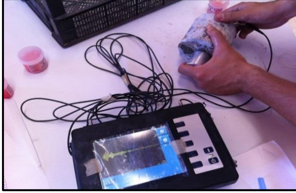
Şekil 2. Ultrases Geçiş Hızı Deneyi (Ultrasonic Pulse Velocity Test)
