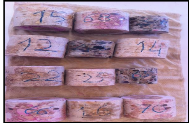
Şekil-5. Karbonatlaşma Renk Değişimi (Carbonating Discoloration)
