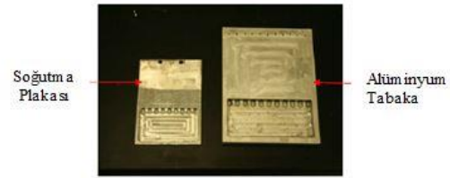
Şekil 8- Soğutma plakası (Chilling Plate) ve Alüminyum tabaka (The chilling plate and aluminum substrate) [16]
