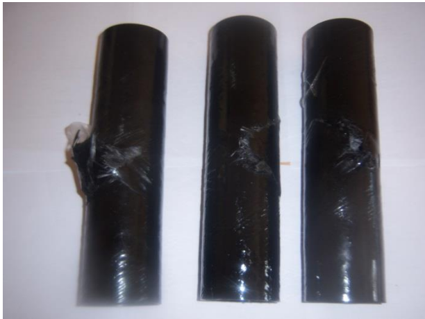
Şekil 10 Çentiksiz, 0,25 çentikli ve 0,50 çentikli %1 CNT takviye edilmiş numuneler patlama sonrası görüntüleri
