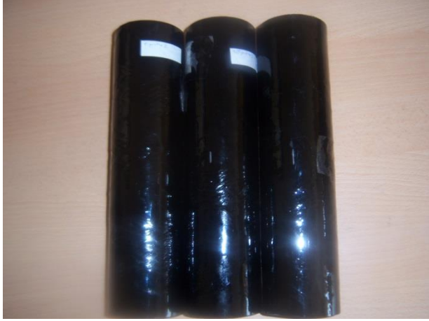
Şekil 9 Yüzey çatlaksız, 0,25 yüzey çatlaklı ve 0,50 yüzey çatlaklı %1 CNT takviye edilmiş numuneler
