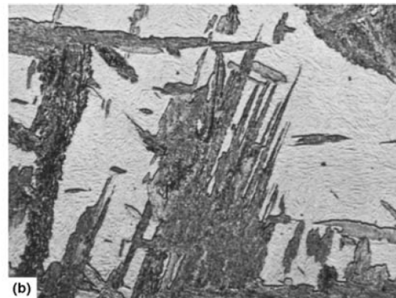
Şekil 2. AISI 4360 çeliğinde üst beynitin mikroyapısı; a) 495°C ve b) 410°C'de izotermal dönüşüm X750, Dağlama: Pikral [1] (Figure 2. The microstructure of upper bainite in AISI 4360 steel isothermally transformed at a) 495°C and b) 410°C, X750, Etchant: Picral [1])
