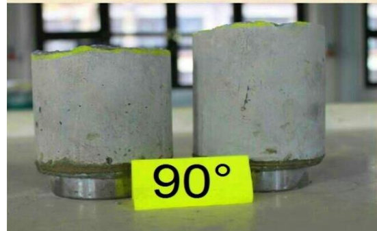
Şekil 5. Doğrudan çekme dayanımı deneyi yapılmış örnek bir görünüm (A view of the experimented samples for direct tensile strength)
