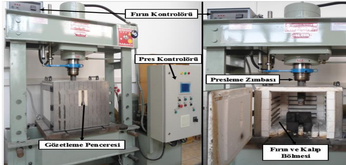
Şekil 3. EKAP deney düzeneği (ECAP Experimental Set-up)
