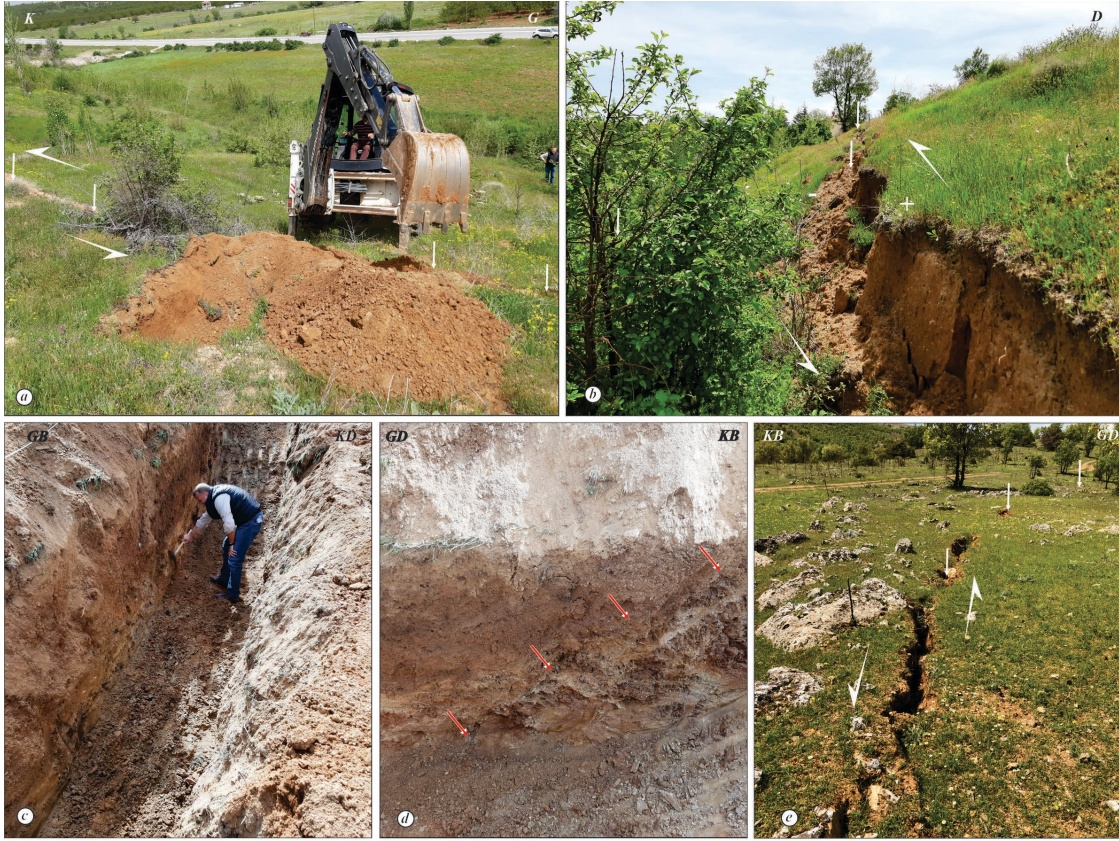
Şekil 6: a) 6 Şubat 2023 ( M_w : 7.6) depremi yüzey kırığı üzerinde gerçekleştirilen Çığlık 3 hendek kazı çalışmaları (37.926045D/38.119882K), b) Yüzey kırığının oluşturduğu 75 cm düşey deęiştirme (37.926562D/38.120301K) c-e) Yüzey kırığının kazı derinlięi boyunca görünümleri ve yorumu Figure 6: a) Ciglık 3 trench studies on surface rupture of February 6, 2023 ( M_w : 7.6) (37.926045E/38.119882N), b) The surface fracture has induced a vertical displacement of 75 cm (37.926562E/38.120301N), c-e) The interpretation of the surface rupture on the floor and trench wall
