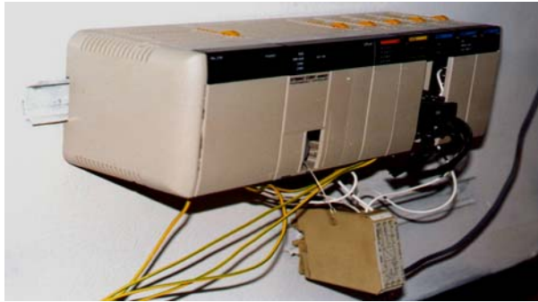
Şekil 4. Omron CPU 41 PLC'nin cihaz kontrol panosuna bağlantı şekli fotoğrafı.
