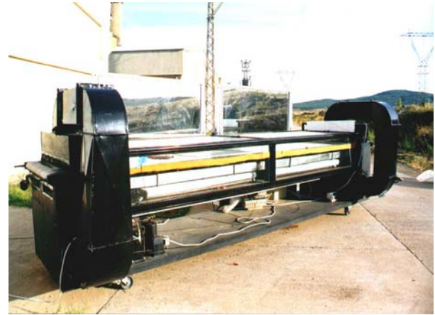
Şekil 1. Güneş enerjili ve ısı depolamalı (PCM) çok amaçlı kurutucunun geri kazanımlı dış hava kanal bağlantılı görünüşü.
