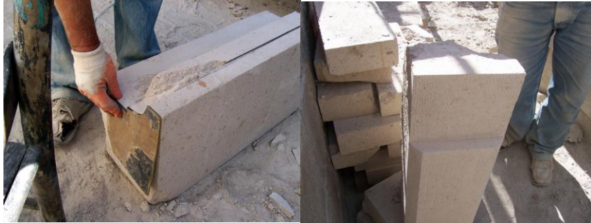
Şekil 2. Taşların kalıplara işlenmesinin görünümü. (Processing of stones from molds)
