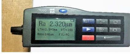
Şekil 2. Yüzey pürüzlülüğü ölçme cihazı (Surface roughness measuring device)
