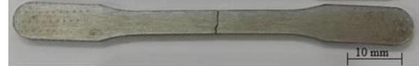
Şekil 2. 1350°C'de 1 saat sinterlenmiş Alaşım 2 test numunesinin çekme testi sonrası genel görüntüsü (General view of tensile test specimen for Alloy-2 sintered at 1350 °C for 1 h)
