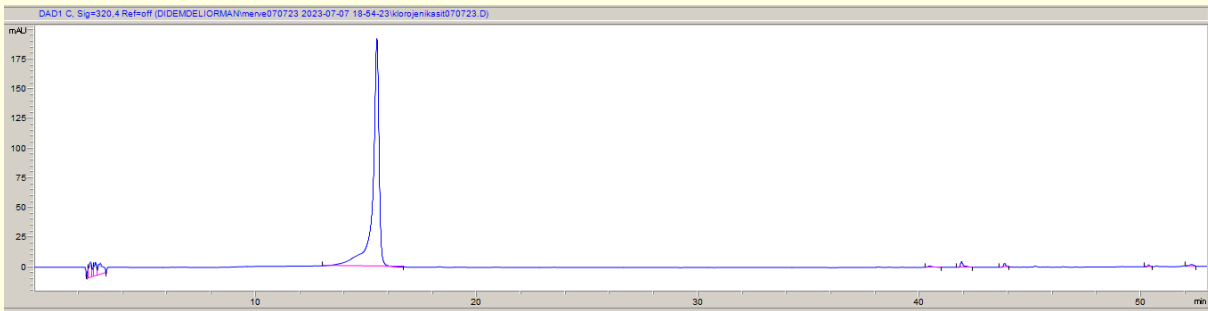
Şekil 3. Klorojenik asit YPSK kromatogramı (280 nm)
