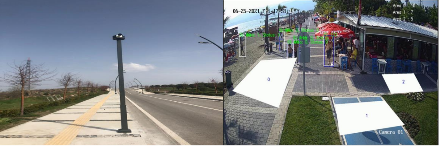
Resim 8: İnsan ve Araç Sayma Kamera Sistemi
