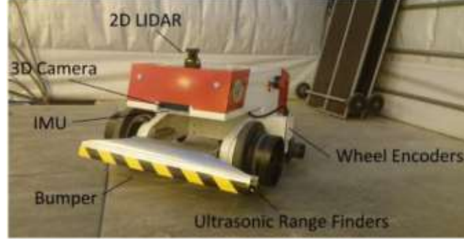
Şekil 9. Sensörlerin otonom tarım robotu üzerinde konumlandırılması (Grimstad ve ark., 2018)
