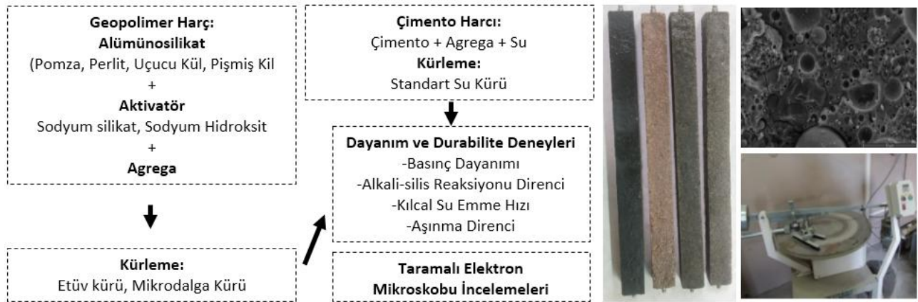
Şekil 1. Çalışma Özeti, ASR Numuneleri, SEM Görüntüsü Örneği ve Böhme Aşınma Cihazı (Summary of the Experimental Study, ASR Specimens, SEM Image and Bohme Abrasion Device)
