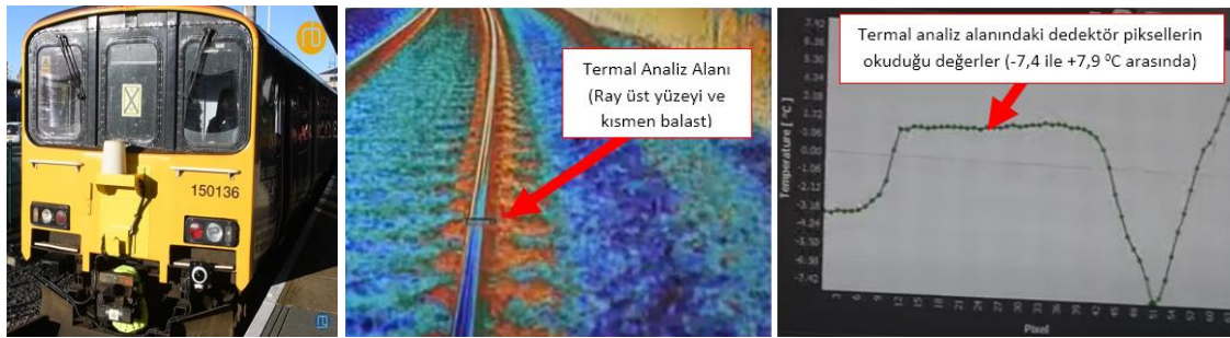
Şekil 3. Seyir halinde hat analizi gerçekleştiren yolcu treni ve termal kamerayla kaydedilen görüntü [13]
