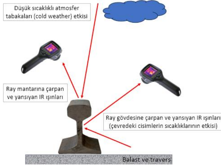
Şekil 5. Termal kamera ile raylardan görüntü alınması esnasında yansıyan sıcaklık değerinin değişkenliği
