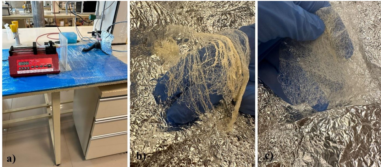
Şekil 2. (a) Elektrospinning düzeneği ile elde edilen (b) PJ ve (c) PJ-ÇE liflerinin görüntüsü.
