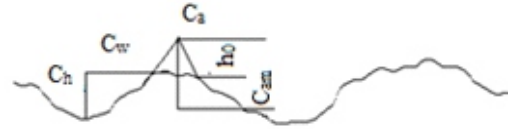
Şekil 2. Kıvrım parametrelerinden bazılarının şematik gösterimi
