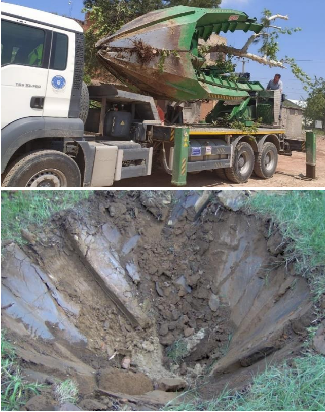
Şekil 5. Söküm taşıma ve dikim yapabilen kamyon (üst) (Resim K.K. Kılıç), ve makinayla açılan dikim çukuru (alt)
