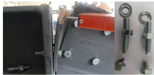
Şekil 10b. T200-Hmax-126 birleşimi için göçme şekilleri [13] (Failure modes for T200-Hmax-126 connection)
