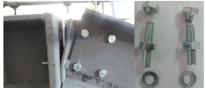
Şekil 10a. T160-Hmax-126 birleşimi için göçme şekilleri [13] (Failure modes for T160-Hmax-126 connection)
