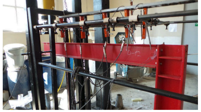
Şekil 4b. Deney düzeneği ve deney numunesi (Test set-up and beam-to column connection)
