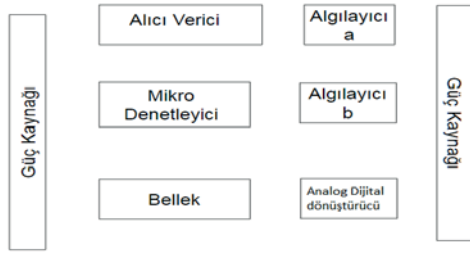
Şekil-4: Önerilen algılayıcı düğümü mimarisi
