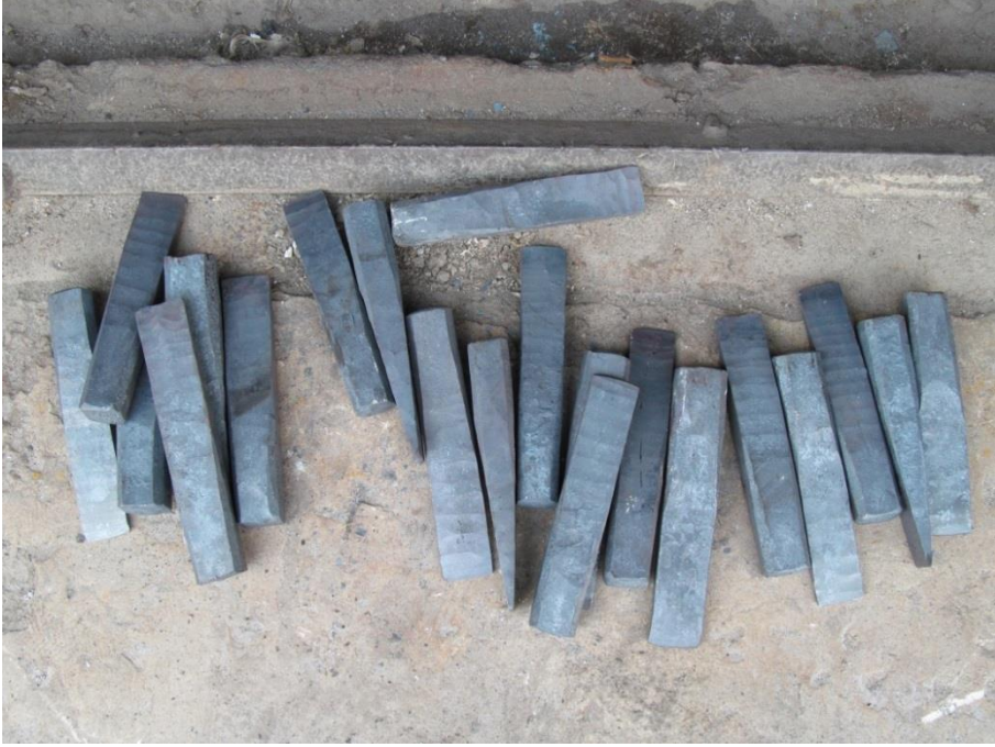
Fotoğraf 21. Çift Başlı Kazma Yapımı (Oluşacak Ana Parça)
