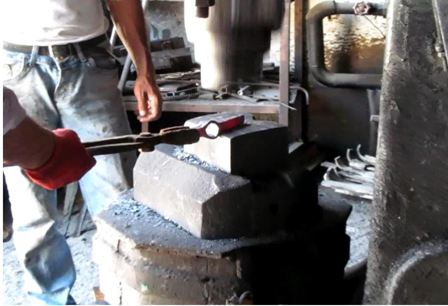
Fotoğraf 24. Oluşan Kazmanın Son Olarak Dövülerek Şekillendirilmesi
