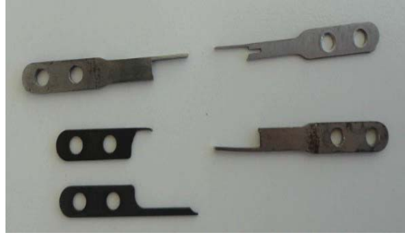
Şekil 9. Kırılan/deforme olan terminal çıkarıcı uçları
