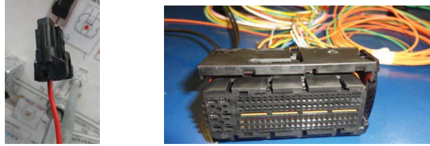
Şekil 5. Tek gözlü ve 105 gözlü soket örnekleri
