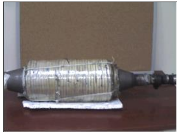
Şekil 2.2. İndüksiyonlu Akışkan Isıtıcısı Deney Sisteminin Kovan Kısmı
