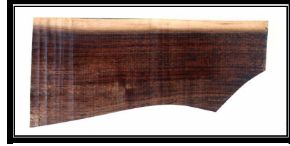
Resim-2. Tam (karabin tipi) ve yarım (otomatik tip) kundak taslakları. Figure-2: Carbine and automatic type of gunstock blanks.
