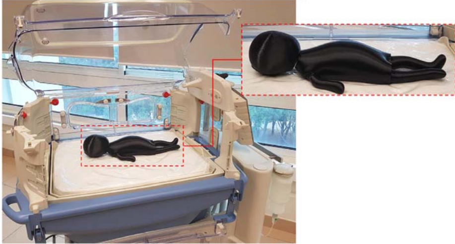
Fig. 12 Preterm thermal mannequin named Calor [28]
