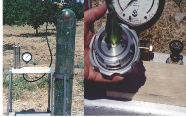
Şekil 1. Basınç hücresi ve yaprağın cihaza yerleştirilmesi. Figure 1. Pressure chamber and place of leaf to the equipment.
