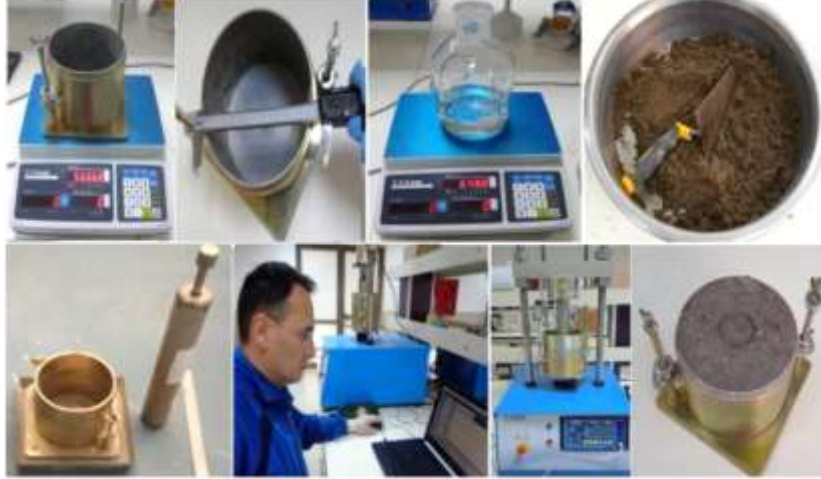
Şekil 5. Kaliforniya taşıma oranı deneyi uygulama aşamaları
