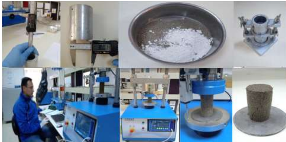
Şekil 4. Serbest Basınç Deneyine ait Uygulama Aşamaları
