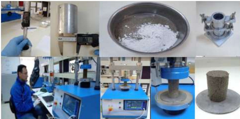
Şekil 4. Serbest Basınç Deneyine ait Uygulama Aşamaları
