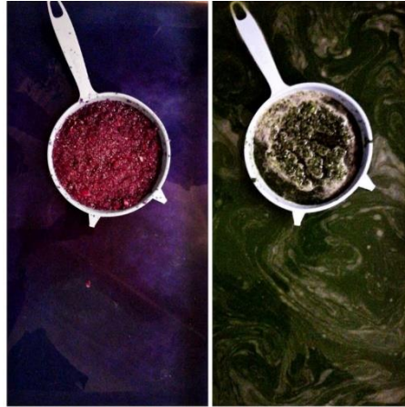
Şekil 9: Kâğıt Hamuruna Kırmızı Lahana ve Ispanak Özlerinin Eklenmesi
