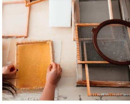
Şekil 5: Kasnağın Üzerindeki Kâğıt Hamurlarının Beze Aktarımı
