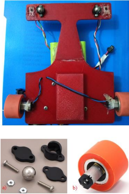
Şekil 5. Kullanılan motor ve tekerlekler, a) polulu sarhoş tekerlek, b) motor ve ağır silikon tekerlek (Anonymous, 2001; Anonim, 2017a)
