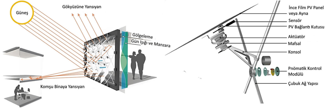
Görsel 8. Uyarlanabilir kinetik güneş cephesi.
