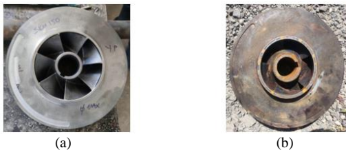
Fig. 2. Centrifugal pump fan a) intact fan and b) faulty fan
