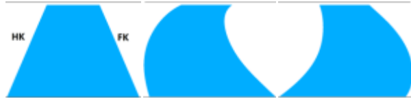
Şekil 3. Fanların r-z düzlemindeki (meridyenel düzlem) görünüşleri.
