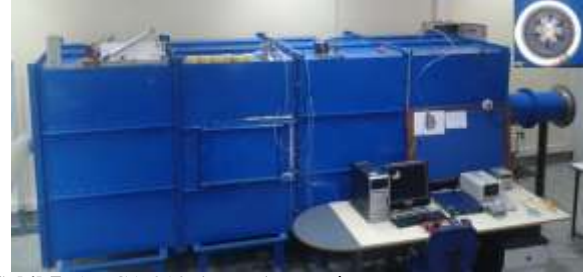
Şekil 7. AMCA 210 deney düzeneği.
