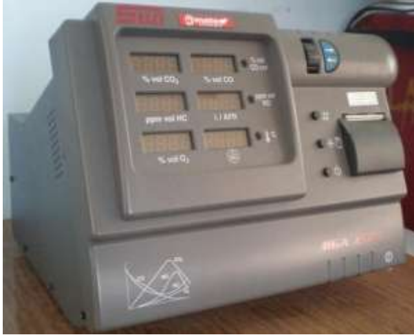
Şekil 3. Sun MGA 1500S egzoz gaz analizörü Egzoz emisyonlarının ölçümünde Şekil 3'te görülen Sun MGA 1500S marka dijital göstergeli egzoz gaz
