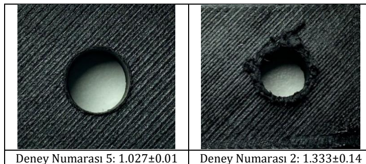
Şekil 11. 3B baskı için en düşük ve en yüksek delaminasyon oranına sahip numunelerin görünümü (View of specimens with the lowest and highest delamination rate for 3D printing)
