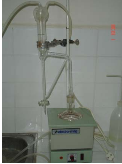
Şekil 2. Uçucu yağ deneylerinde kullanılan Clevenger aparatı (Fotoğraf: Tümen, İ.)
