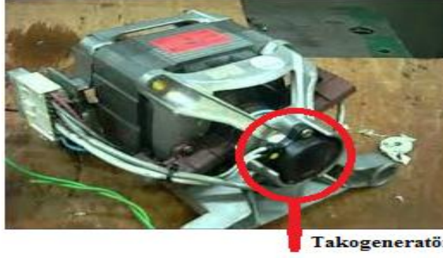
Şekil 6.' Üniversal motora akuple bağlı takogeneratör
