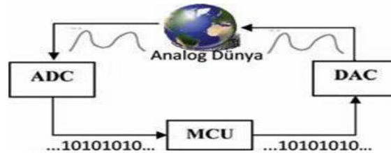
Şekil 3. Mikrodnetleyici tabanlı bir sistemde işlenerek sonrasında tekrar analog sinyale çevrilmesi adımları.
