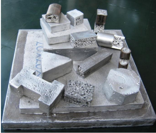
Şekil 1. Al esaslı kapalı gözenekli metalik köpük malzemeler (25x25x20 mm 3 )
