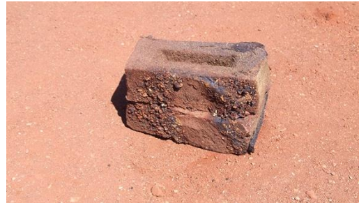
Şekil 24. Fazla Isı Sebebi ile Zinterleşmiş Tuğlalar.
