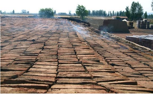
Şekil 20. Yanmakta Olan Sahra Fırının Üstten Görüntüsü.
