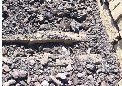
Şekil 16. Fırın Tabanında Yükleme Sırasında Oluşturmuş Izgara.
