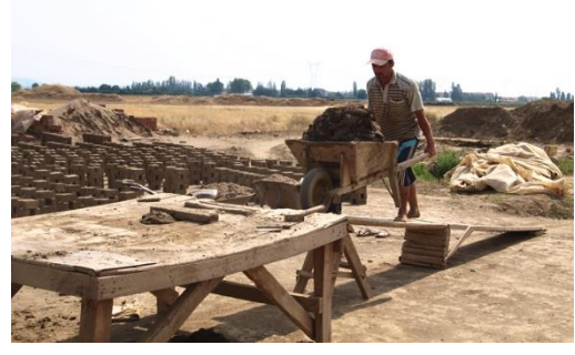
Şekil 6. Çamurun Havuzdan Taşınması.
