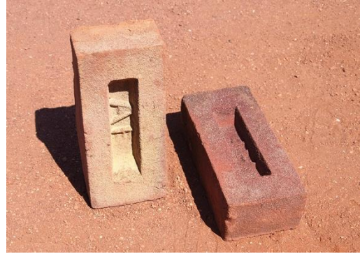
Şekil 23. 18,5 x 8,5 x 5,5 Ölçülerinde Tuğlalar.
