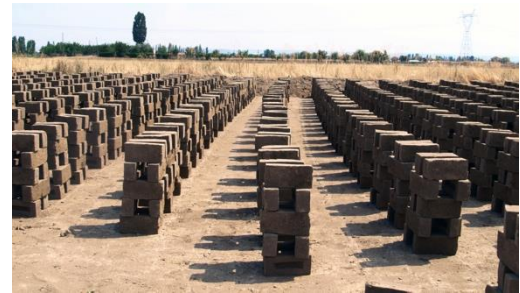
Şekil 12. Kafes Adı Verilen Sistemle Dizilmiş Tuğlalar.
