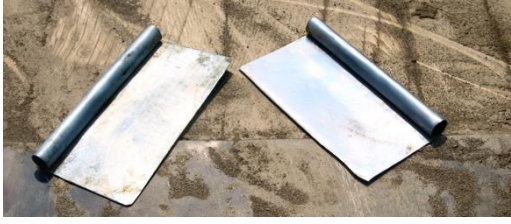
Şekil 8. Kalıptan Fazla Çamurun Sıyırılmasını Sağlayan El Aletleri.
