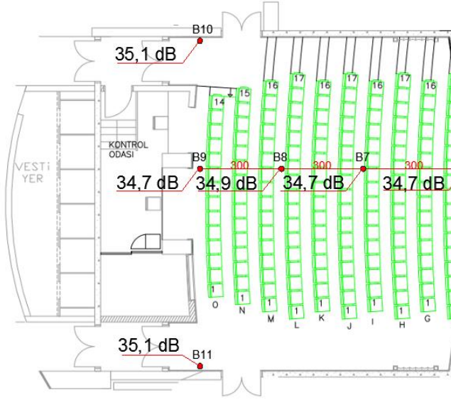
Şekil 2. Ahmed Adnan Saygun Sanat Merkezi(AASSM) küçük salonunda ses yokken yapılan ölçümler
