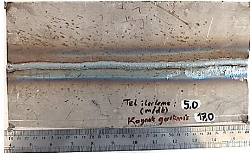
Şekil 2. Kaynak işlemi uygulanmış plakanın yatay görüntüsü (300 mm) (Horizontal view of the welded plate (300 mm))
