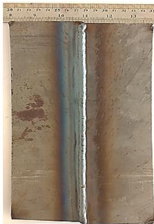
Şekil 3. Kaynak işlemi uygulanmış plakanın yatay görüntüsü (150 mm) (Vertical view of the welded plate (150 mm))
