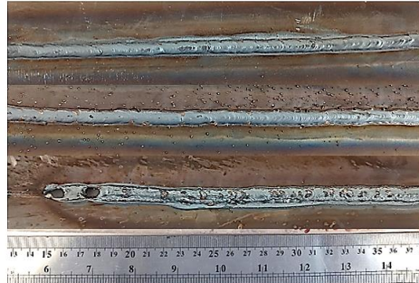
Şekil 7. 2A, 2B ve 2C kaynaklı plakalara ait kaynak dikişleri (sırasıyla) (Weld seams of 2A, 2B and 2C welded plates (respectively))
