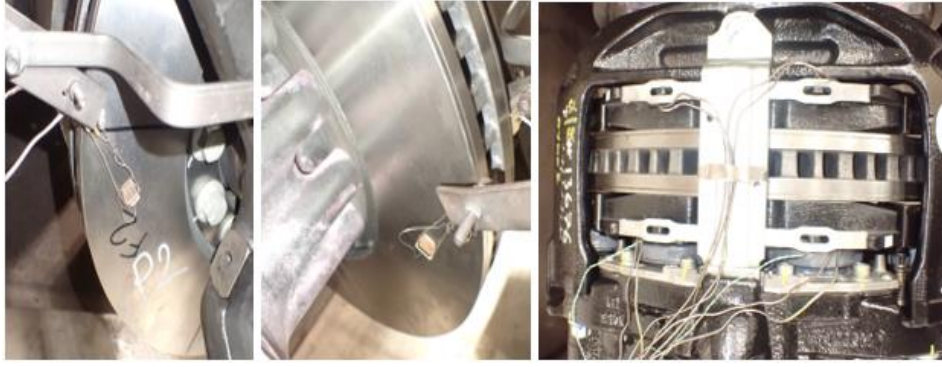
Şekil 5. K tipi termokupulların ölçüm sistemi üzerindeki yerleşimi (Placement of type K thermocouples on the measurement system)
