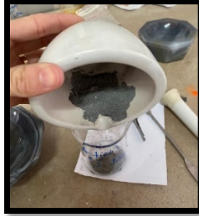
Görsel 3. Şeyma Durnalı, Hammaddelerin Cam beher içerisinde Konulması, 2023, Arşiv Havan içerisinde öğütülen hammaddelerin homojen bir şekilde karıştırılması için cam beher içerisinde koyulması (Görsel 3).
