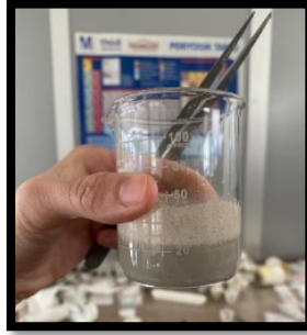
Görsel 4. Şeyma Durnalı, Karıştırılarak Homojen Hale Getirilmesi, 2023, Arşiv Cam beher içerisinde koyulan hammaddelere su ilave edilerek homojen hale gelecek şekilde karıştırılması (Görsel 4).
