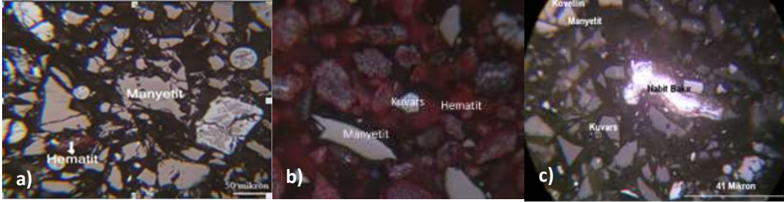
Şekil 1. Manyetit (a), pirit külü (b) bakır cürufu (c) örneklerinin cevher mikroskopunda görünümü (Figure 1. Microscopic examination of Magnetite (a) , pyrite ash (b) and copper slag (c))
