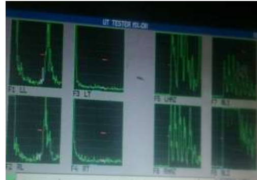
Şekil 2. Kaynak bölgesinin a) radyografik, b) ultrasonik muayenenin çalışma ekranındaki görüntüleri (Figure 2. Images on the working screen of the welded zone a) radiographic, b) ultrasonic)
