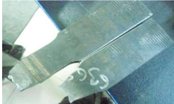
Şekil 3. Kaynatılmış çekme numunesi (Figure 3. Welded tensile Sample)
