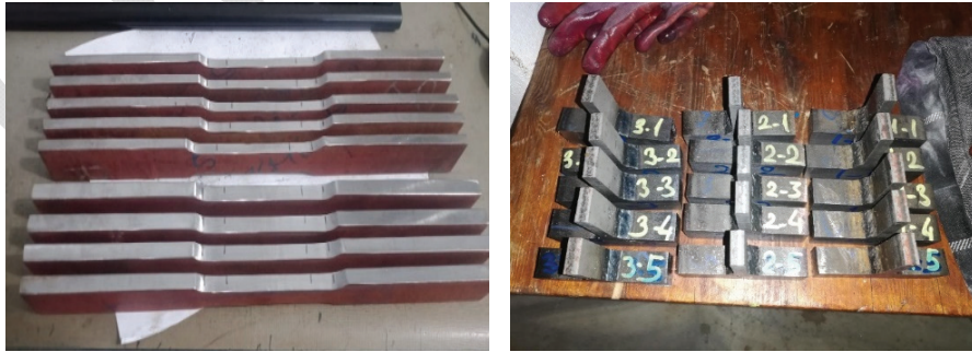
Şekil 2.7 - IPE270 S275JR kiriş gövde ve flanş için çekme numuneleri ile kaynak makro test numuneleri
