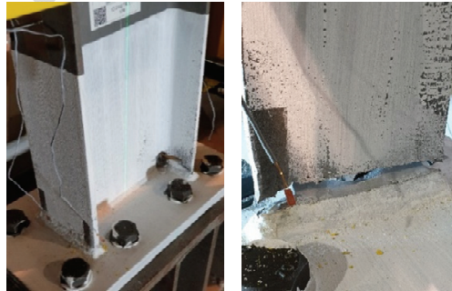
Şekil 3.4 - TB.1.1 çevrim sayısı 27, flanş kaynağında kırılma.
