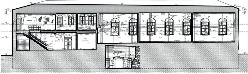
Ç.6- Safvetî Tekkesi kesit (Almira Mimarlık)
