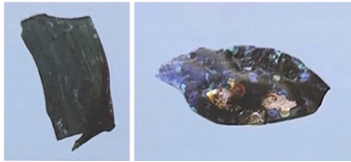
Görsel 7. Üretim Hatası Pencere Camı Parçası (Sol) ve Deforme Olmuş Pencere Camı Parçası (Sağ)
