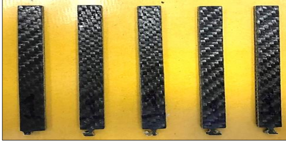
Şekil 12. Eğme testi numuneleri (80 mm×10 mm)
