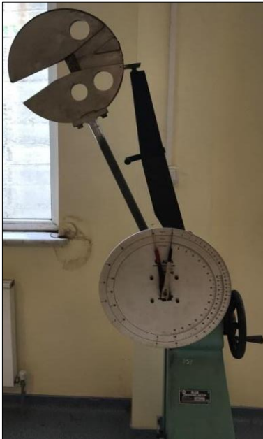
Şekil 6. Darbe dayanımı test cihazı Figure 6. Impact strength tester
