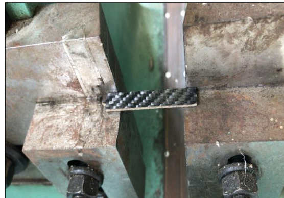
Şekil 7. Çentiksiz Charpy darbe testi numune (55 mm x 10 mm) örnekleri
